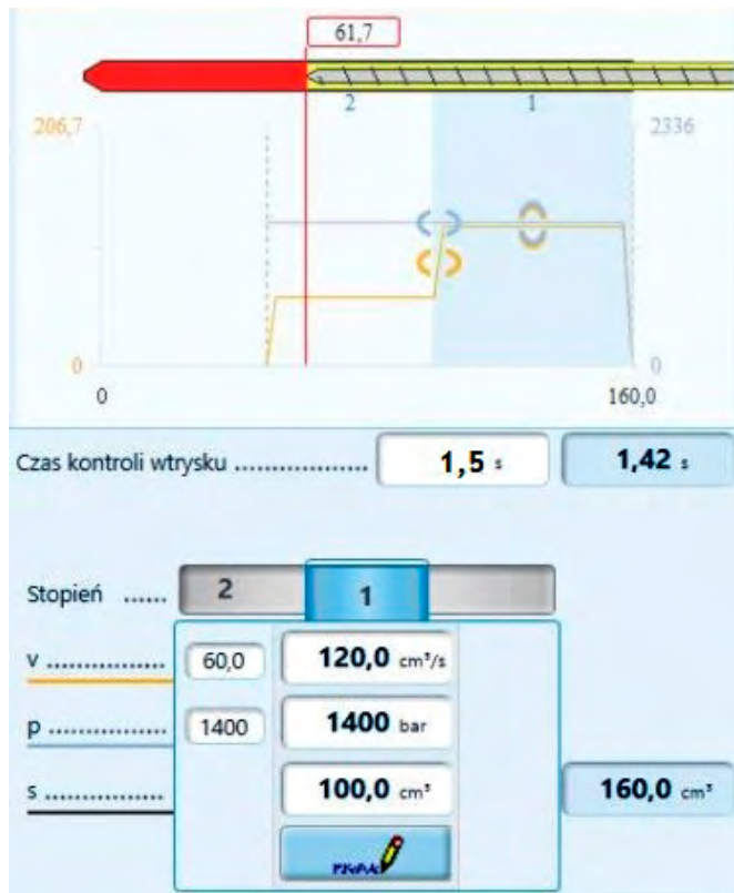
Rys. 5 | Przykładowy profil wtrysku z wykorzystaniem dwóch stopni (źródło: opr. własne)
