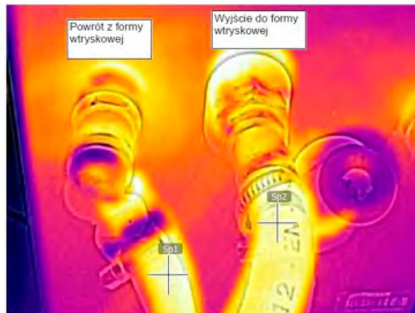
Rys. 3 | Termogram przewodów wodnych obrazujący temperaturę przewodu na wyjściu do formy wtryskowej i na powrocie z formy wtryskowej z akceptowalnym odchyleniem (źródło: opr. własne)
